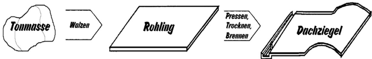
Zur Herstellung eines Rohlings benötigt man 4,32 kg Tonmasse.
