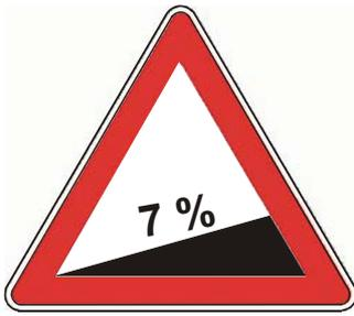
Steigungen von Straßen werden in Prozent angegeben. Beispielsweise bedeuten 7 %, dass auf 100 m horizontaler Entfernung 7 m Höhenunterschied überwunden werden (siehe Skizze).
